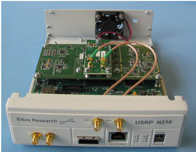
Abbildung 4.1.: Ettus USRP N210 Hardware mit WBX Daughterboard
